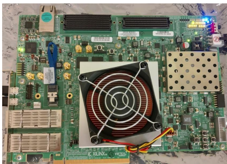
Le processeur de l'ordinateur Morpheus (situé dans l'emplacement carré sous le ventilateur) modifie rapidement et continuellement sa structure sous-jacente pour déjouer les pirates informatiques. © Todd Austin
